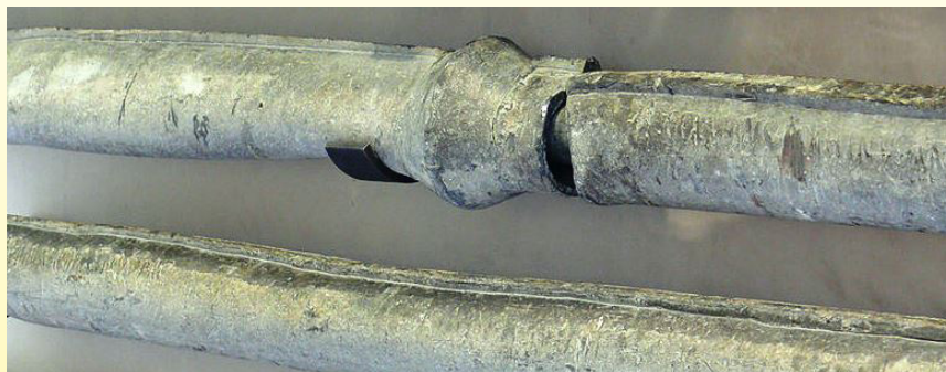
Tuyau romain en plomb soudé, fait de bandes soudées (Musée de l'Arles et de la Provence antique) (extraite de https://commons.wikimedia.org/w/index.php?curid=10214375 )
